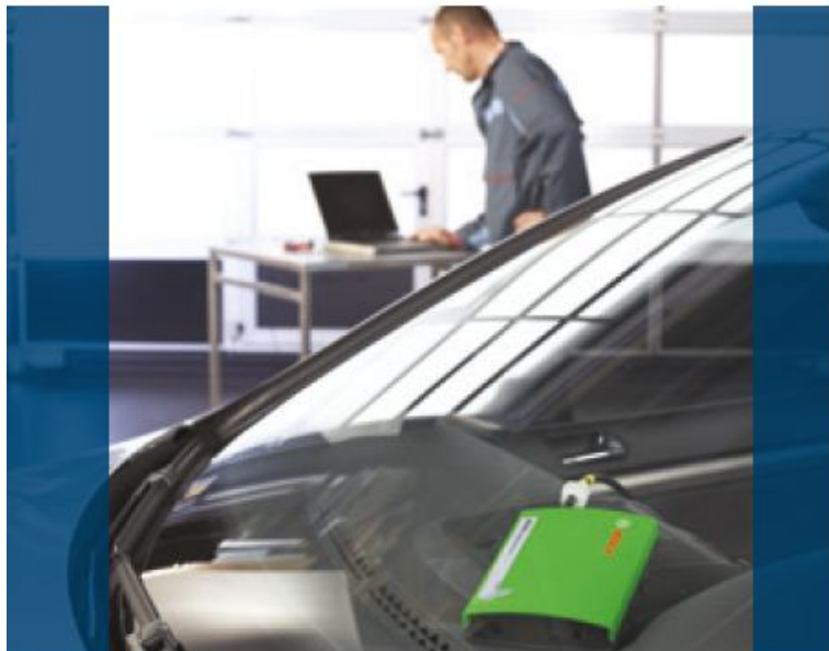
Scambio dati via radio: dal KTS 570 / 540 wireless al PC
